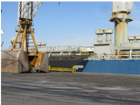
Figura 19: Barreira protetora no navio para movimentação de carga no cais.
