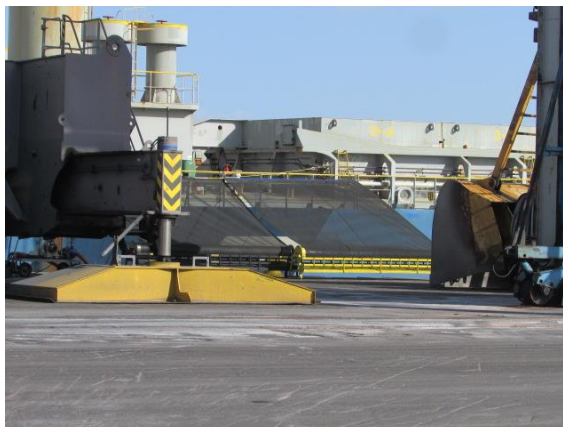
Figura 20: Barreira protetora no navio para movimentação de carga no cais.
