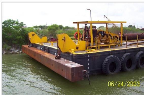
Figura 21. Exemplo de equipamento adaptado para uso em nivelamento de fundo. Foto: Weeks Marine.
