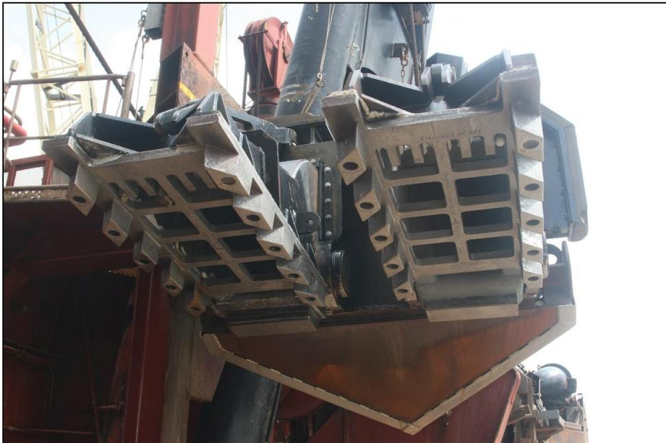
Figura 10. Exemplo de grades instaladas na cabeça de dragagem. Foto: Tim Welp, USACE.
