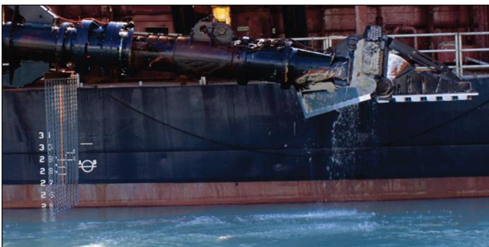
Figura 8. Exemplos de defletores instalados flexíveis (de correntes – a esquerda) e defletor rígido (a direita) instalado em uma draga. Foto: Dena Dickerson.
