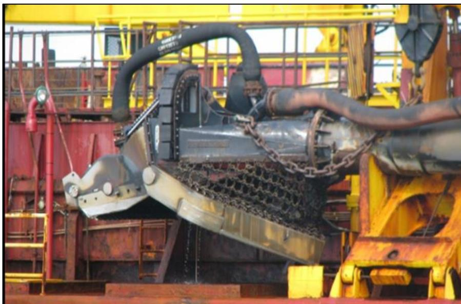
Figura 7. Exemplo de defletor semirrígido articulado com “plataforma fechada” por uma malha de correntes. Fotos: Dena Dickerson.
