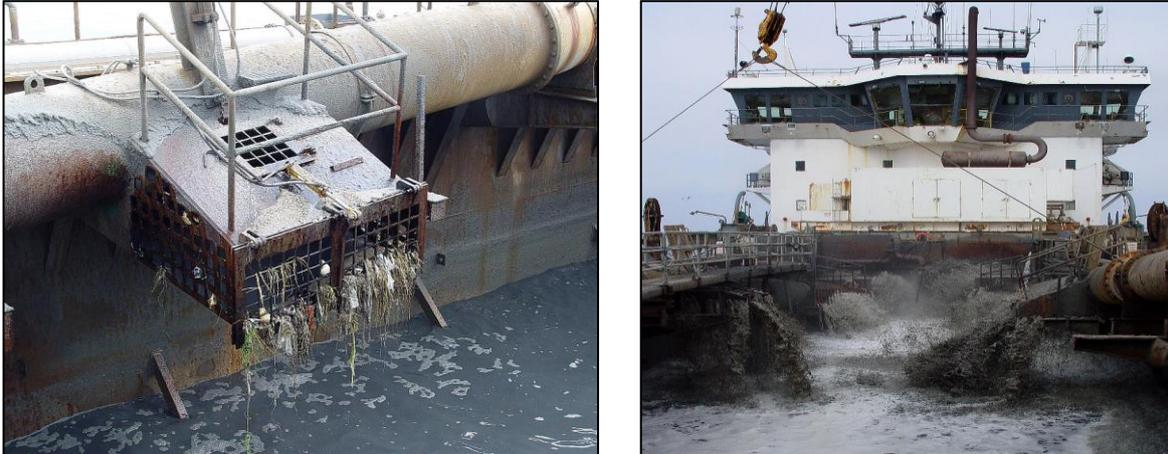
Figura 15. Exemplo de caixa de triagem de material dragado (*inflow screen*) antes do despejo cisterna. Foto: Matthew Godfrey.
