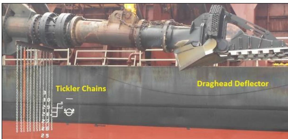
Figura 3. Exemplos de defletores instalados flexíveis (de correntes – *Tickler chains*) e defletor rígido (*Draghead deflector*) instalado em uma draga. Foto: Dena Dickerson.
