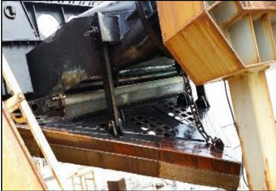
Figura 5. Exemplo de design de defletor com "plataforma aberta". Foto: Dena Dickerson.
