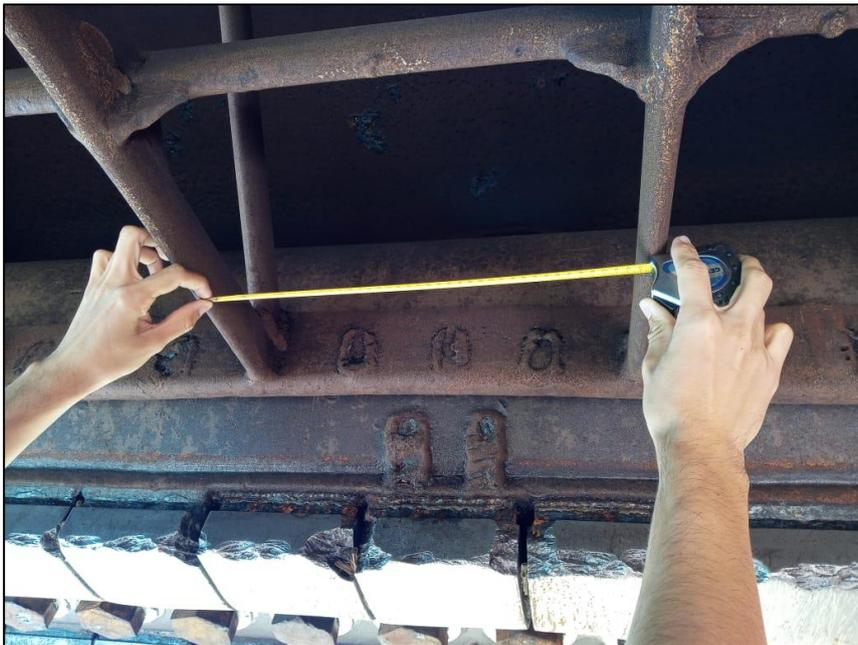
Figura 11. Exemplo de grades instaladas nas dimensões solicitadas na cabeça de dragagem no Porto do Açu. Foto: Control Ambiental.
