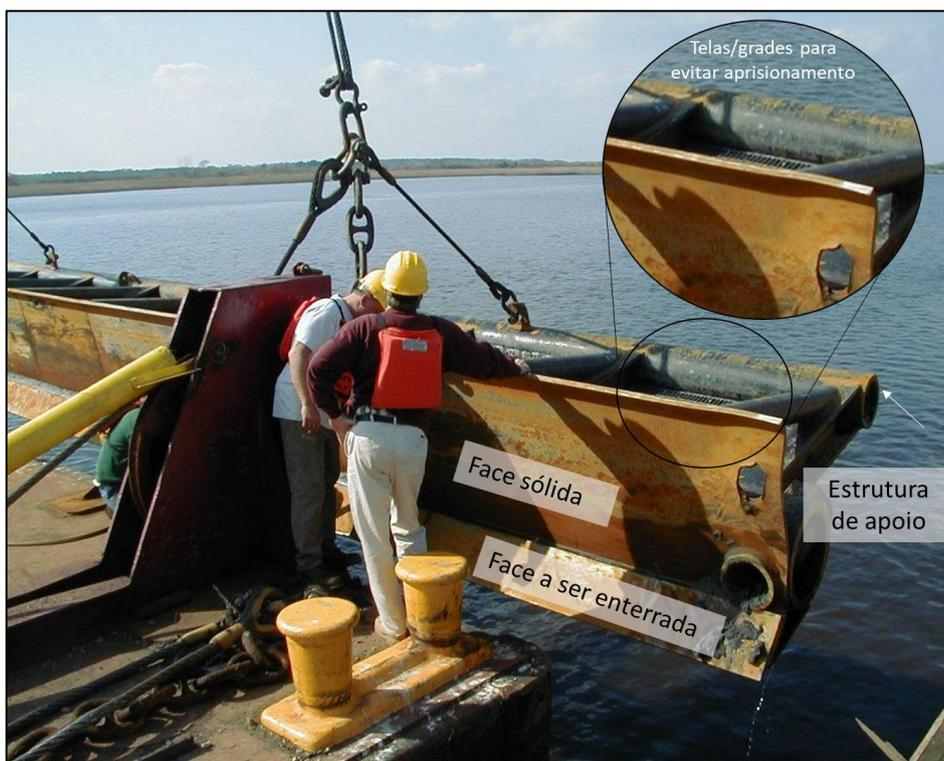
Figura 22. Detalhes dos aspectos importantes para um nivelador a ser mobilizado no Porto do Açú. Fonte: Modificado de Great Lakes Dredge and Dock Co.
