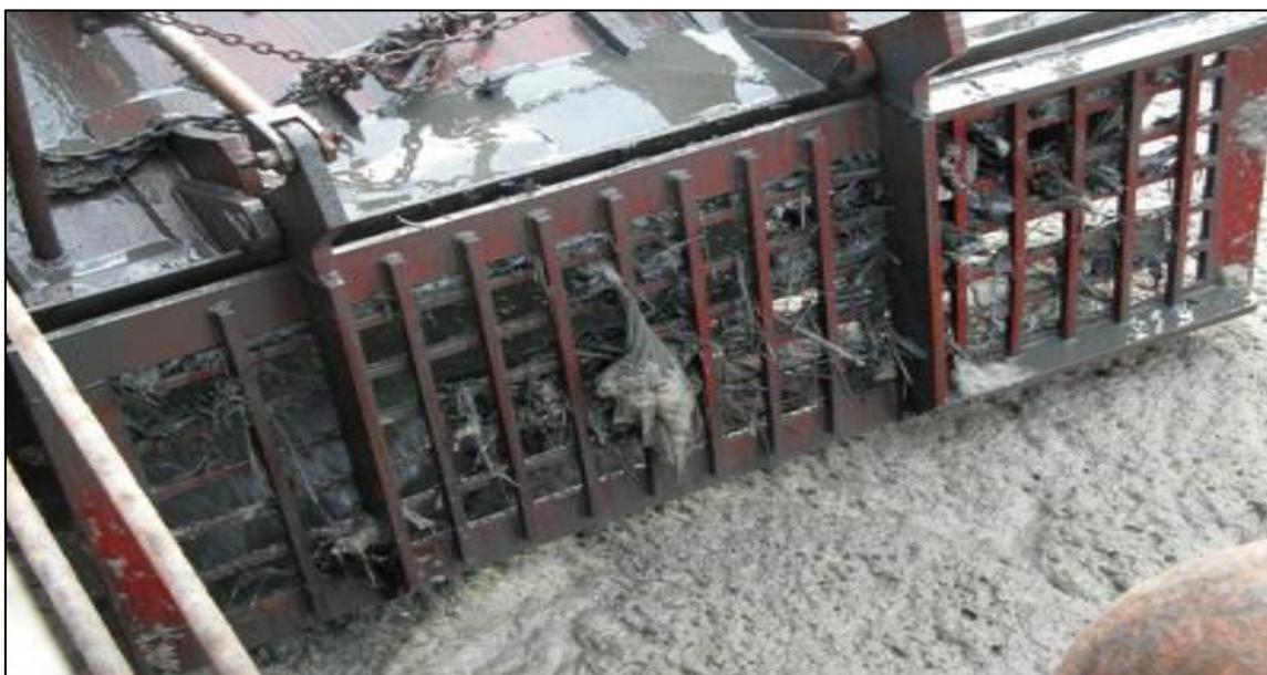
Figura 14. Exemplo de dispositivo para filtrar o material dragado antes da entrada na cisterna (*inflow screen*). Foto: Dena Dickerson.
