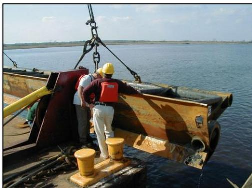
Figura 20. Exemplo de nivelador de fundo desenhado para criar uma onda de sedimento arrastados. Foto: Great Lakes Dredge and Dock Co.
