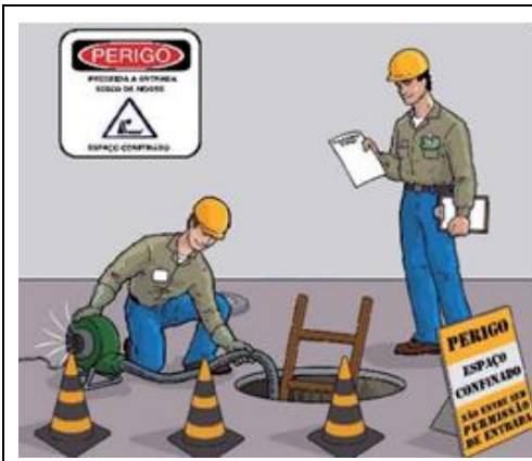
Ventilação e Sinalização (Fundacentro, 2009)
