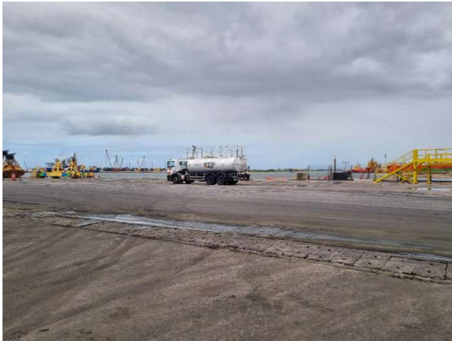
Figura 4-8 – Caminhão Pipa utilizado na umectação de vias e pátios no T-MULT
