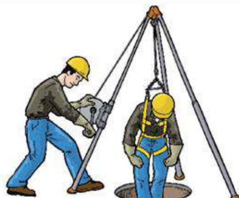
Entrada no Espaço Confinado
