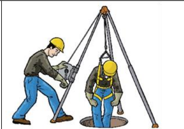
Entrada no Espaço Confinado (Fundacentro, 2009)
