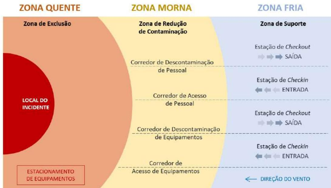
Figura 6 - Representação esquemática dos locais de descontaminação (situados na "Zona Morna") no zoneamento das áreas de resposta à emergência. (Fonte: Adaptado de NUKA, 2014).
