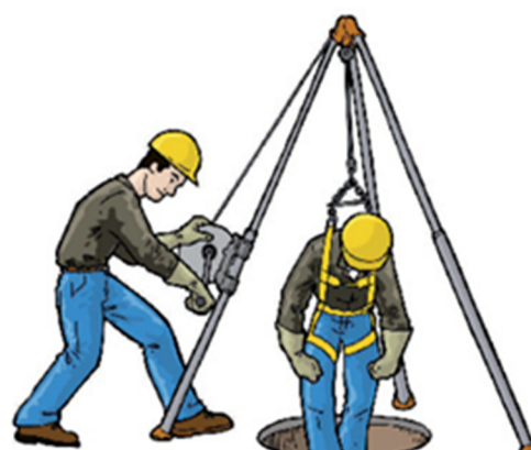
Entrada no Espaço Confinado
