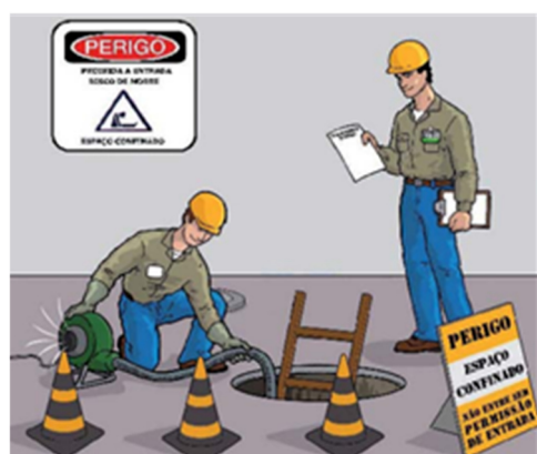
Ventilação e Sinalização
